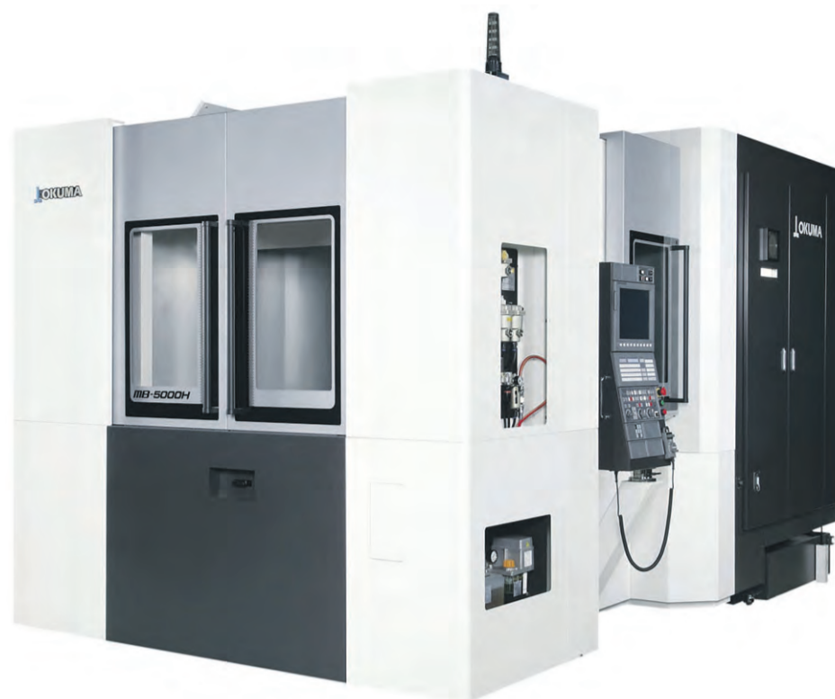
Det fire-aksede powerfulde og præcise MB-5000 H-center, som Flextek aktuelt slår et slag for, er forsynet med den seneste OSP-300M-styring.
