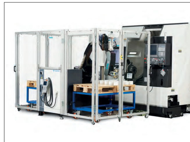
Flexteks flytbare robotcelle MH24, som er skabt ubemanded produktion.
