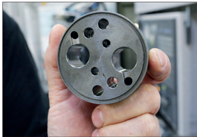
Der er tale om et hydraulikemne med 18 millimeter huller med en tolerance på under plus/minus fem mymeter.
