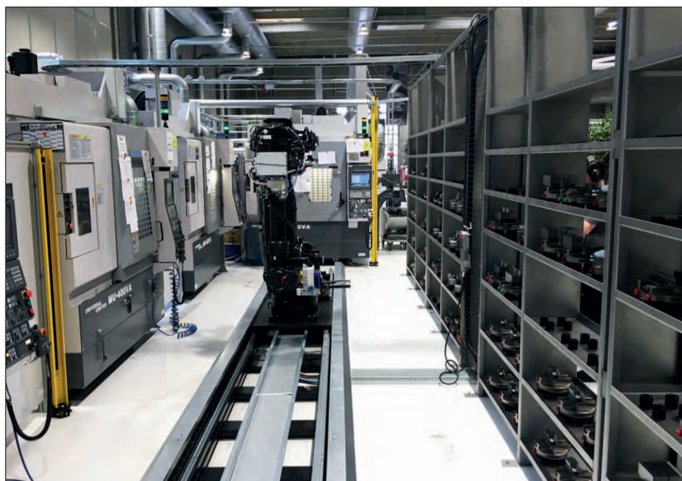
Opspændingssystemet til robotløsningen er med til at muliggøre mange forskellige serier efter hinanden på de samme maskiner, fremhæver Welltec A/S.
