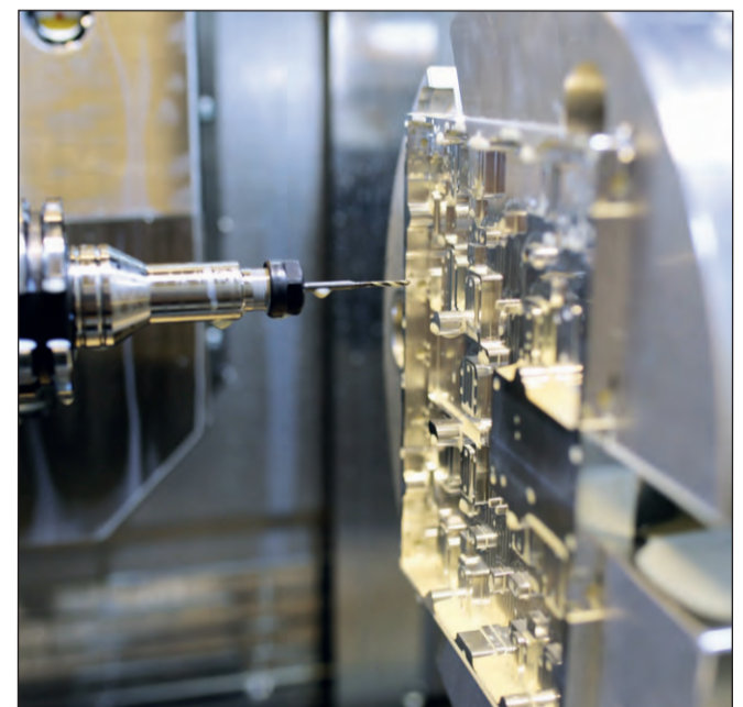
På billedet et af de første aluminium-emner (til indkapsling af radarelektronik), der er fundet bedst egnet til at blive fremstillet med Multitasking-bearbejdningscenteret.
